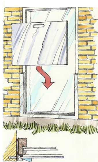
Figur 2: Skot foran vindue
